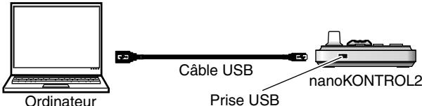
1. Reliez le nanoKONTROL2 à un port USB de votre ordinateur avec un câble USB. Le nanoKONTROL2 est mis sous tension et son témoin d'alimentation s'allume.
