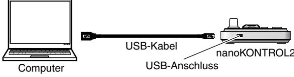
1. Über diesen Port können Sie das nanoKEY2 mit Hilfe eines USB-Kabels mit einem USB-Port Ihres Computers verbinden. Das nanoKONTROL2 wird eingeschaltet und die Netzanzeige leuchtet.
