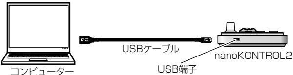
1. nanoKONTROL2とコンピューターのUSB端子をUSBケーブルで接続します。電源が入り、パワーLEDが点灯します。
